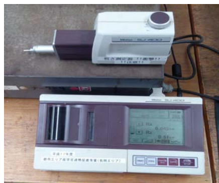
Fig. 5.24 Fotografia instrumentu hodi sukat rugosidade
