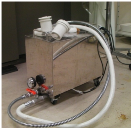
Fig. 4.2. Fotografia gerador micro-bolhas nian
