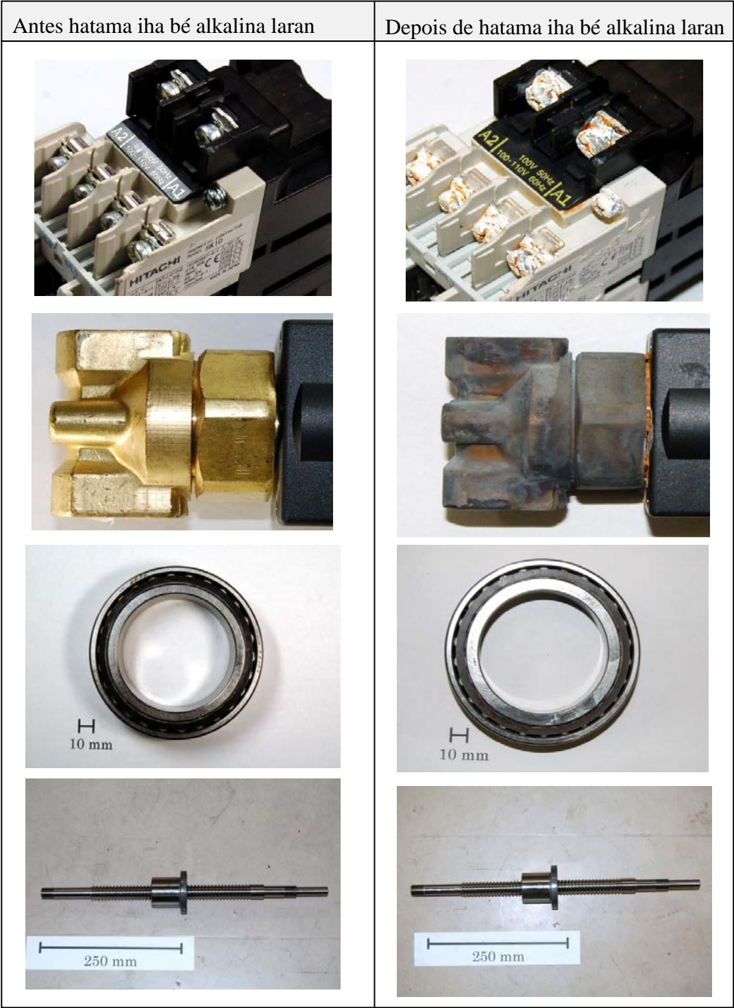
Fig. 5.2 Fotografia husi materiais balun depois no antes hatama iha bé alkalina laran
