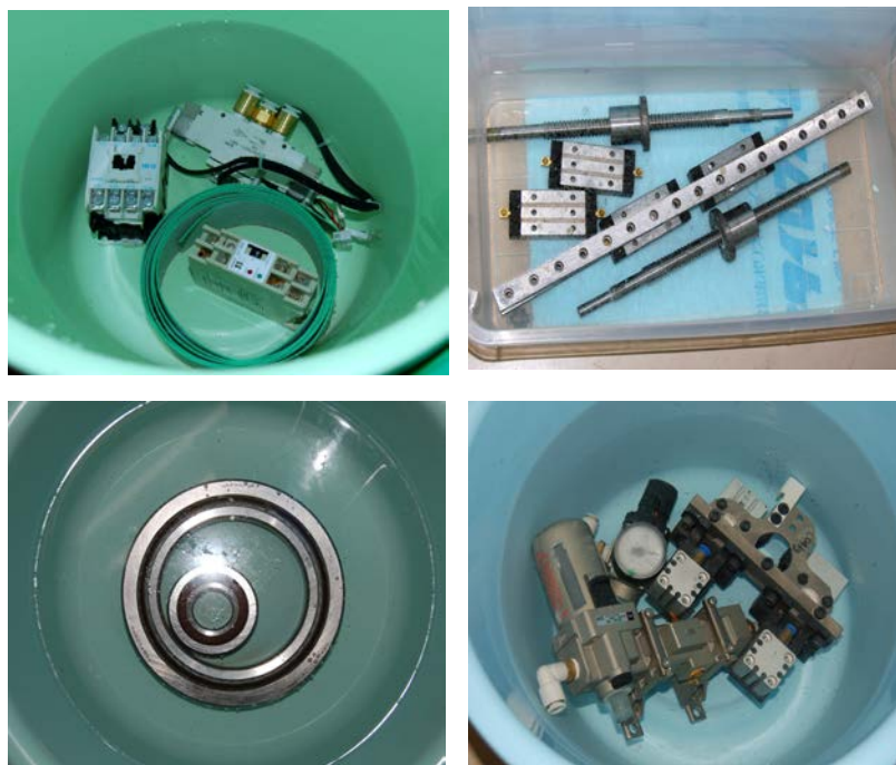
Fig 5.1 Fotografia husi materiais balun neebe immerse iha bé alkalina laran
