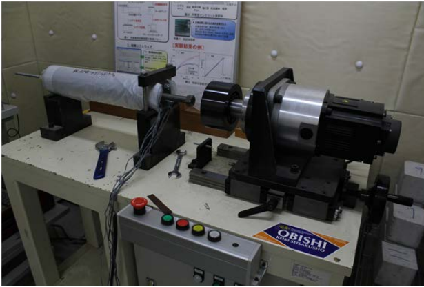
図3 持続载荷試験装置
