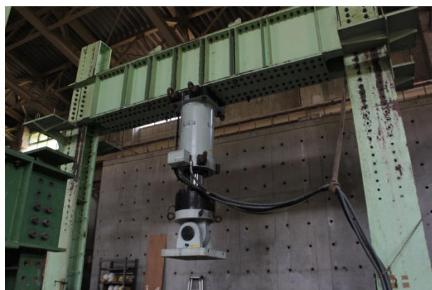
図 1 構造物の耐震性能試験システム
