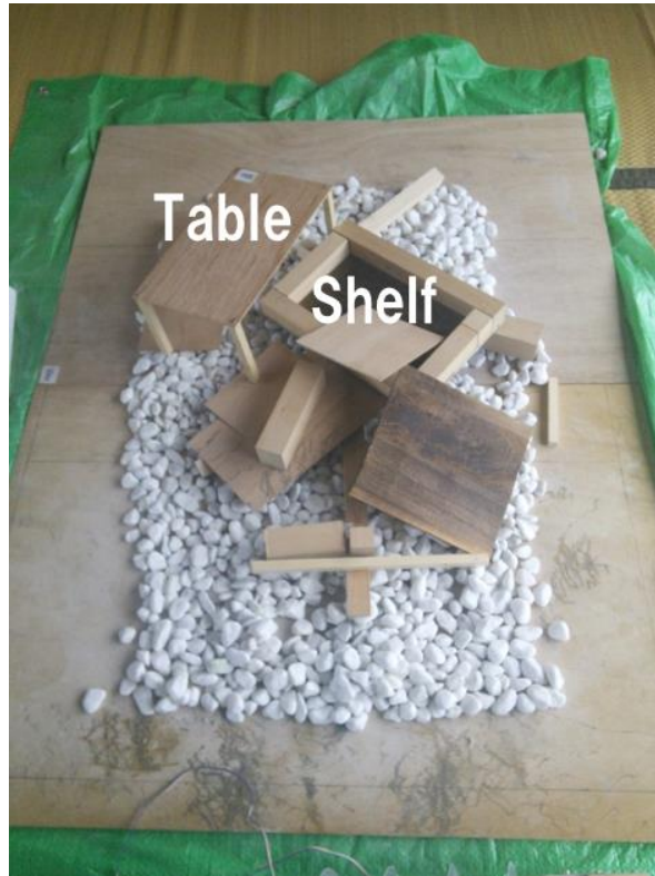
Fig.5-71 瓦礫モデル実験フィールド概観 机と棚のモデルは自宅の実物を計測し，1/6 サイズにした．
