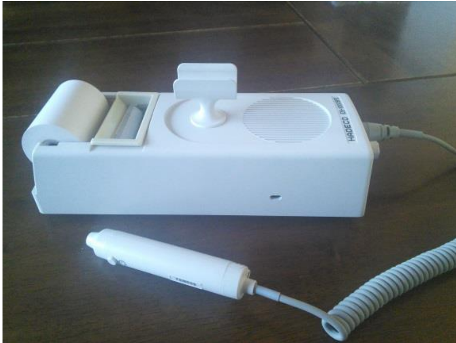
Fig.6-10 超音波ドプラ血流計 ES-1000SP II とそのプローブ T8M05S PC へのデジタル出力は無く，感熱シリアルドット方式でのプリントアウトの出力のみ であり，リアルタイムでの計測が出来ない。
