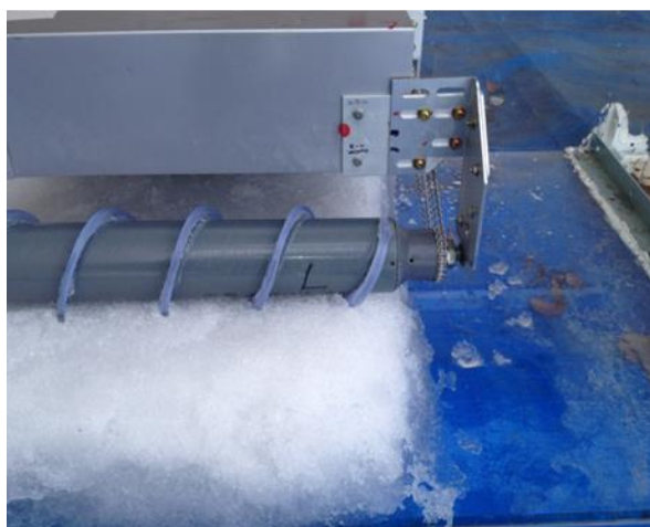
Fig.5-52 実験における始点の定義 始点の目印に螺旋ロッド最後方部を合わせて、測定を行った。
