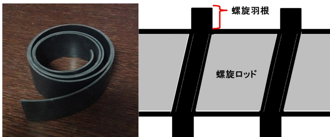
Fig.5-14 使用した天然ゴムロール (左) 作成した螺旋羽根の構造図 (右) ゴムロールは 1mm 厚の物を使用. 羽根の形状は正方形で軟質である.
