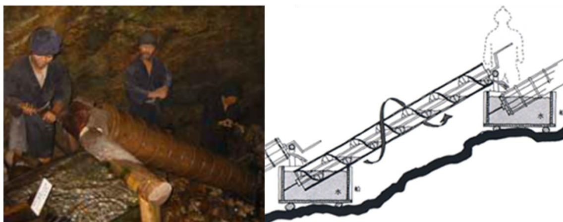
Fig.3-10 承応 2 年 (1653) より佐渡金山で使用された水上輪 (すいしょうりん, 左) とその構造 (右)
