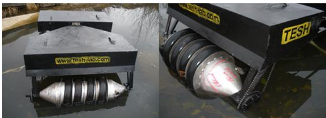
Fig.5-91 スクリューの平行配置を前提とした移動体 TESH-drive (ロシア) IdeaConnection HP: “Re-inventing the Screw-Propulsion Vehicle” ページより転載, http://www.ideaconnection.com/invention-success/Re-inventing-the-Screw-Propulsion-Vehicle-00249.html , 最終アクセス日 2014/11/21
