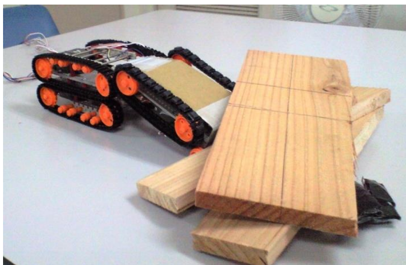
Fig.4-2 こじあげ機構を備えたキャリア・ユニットの1/10縮尺模型 瓦礫モデルとしての木板（図右）をこじ開け機構で持ち上げる様子．
