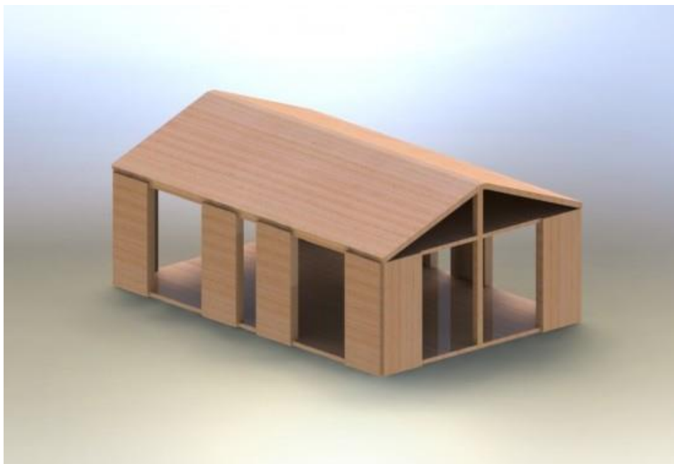
Fig.4-4 日本家屋の3次元モデル (縮尺比率 1/10) 新潟県中越地震にて倒壊した家屋 (小千谷市) を基に設計.
