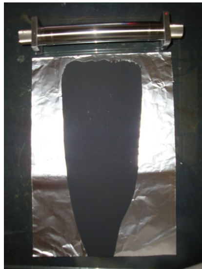
Fig.2.7 塗工乾燥後の正極電極およびバーコーター写真(中央銀色が Al 箔であり、この Al 箔中央部分の濃い灰色部分が正極スラリー塗布部分である。充放電試験では、この塗工部分を打ち抜き試験を行った。尚、Al 箔上部の円柱状のものがバーコーターである。)
