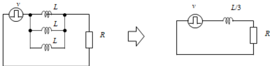
図 3-10 インターリーブ一括電流制御等価回路
