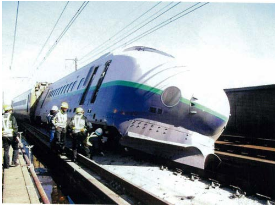
図 2-22 上越新幹線の脱線状況 50)
