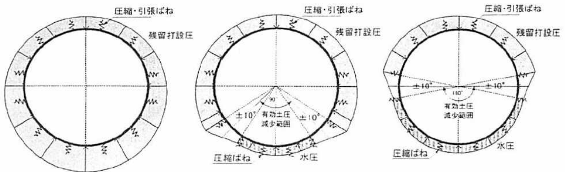
(a) モデル 1 (有効土圧の減少なし) (b) モデル 2 (有効土圧の減少の範囲 90^\circ \sim 180^\circ )
