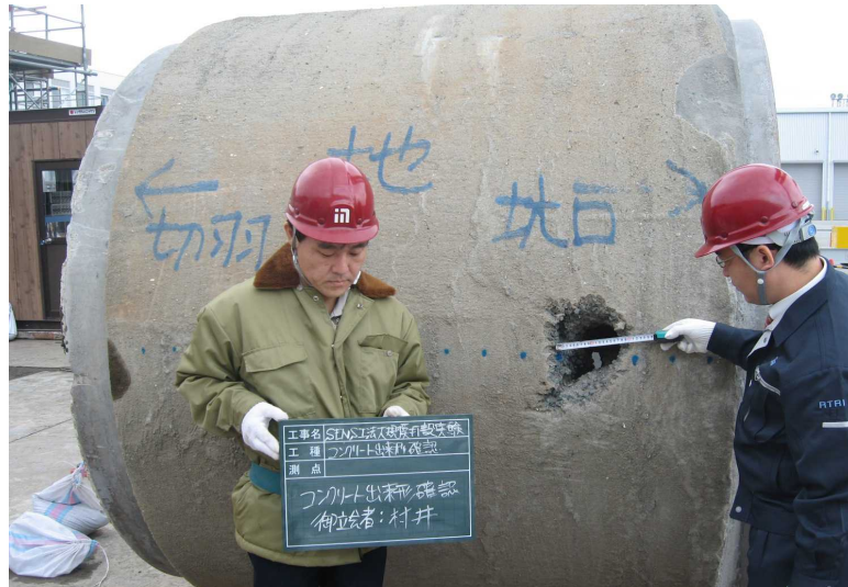
写真 1-5 大型実験での結果（水中分離抵抗性混和材が無い場合） 21)
