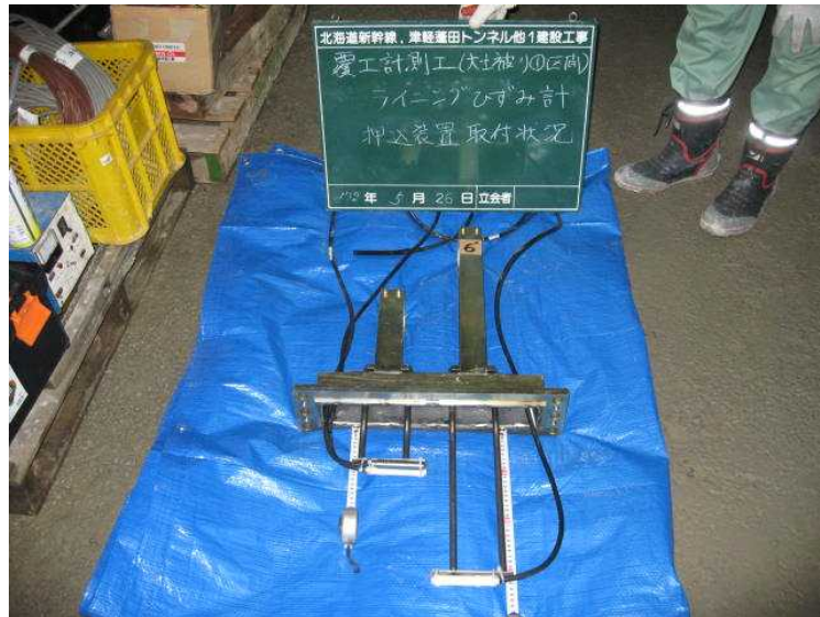
写真 2-3 ひずみ計押し込み装置
