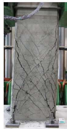
写真 5. 4. 1 荷重後の損傷状況 (D0)
