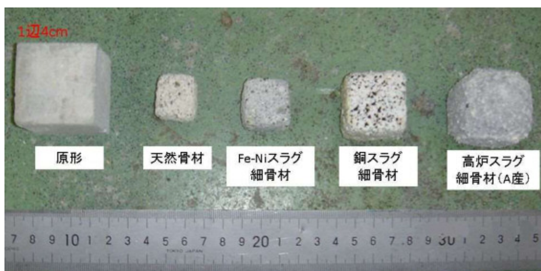
写真 6-1 硫酸浸漬 32 日後のモルタルの外観
