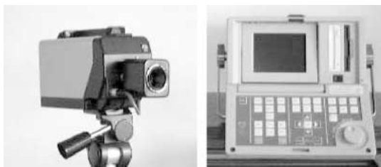
Fig. 4 サーモグラフィ装置外観
