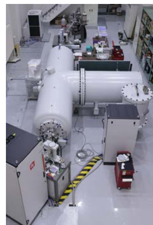
タンデム型静電加速器
