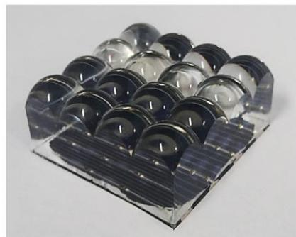
(c) 部分集光モジュール (高透過 CPV モジュール+両面 Si セル)
