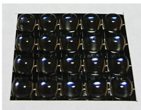
(c) 部分集光モジュール (CPV モジュール+ Si セル)
