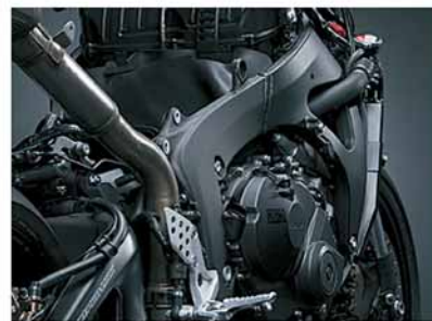
図4 溶接接合されたフレーム
