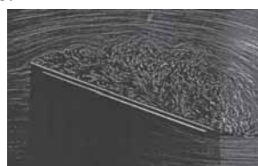
Figura 3. Flujo real alrededor de un panel
