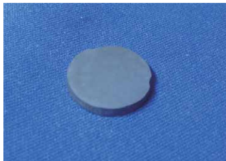
図4 Mg 2 Si 熱電材料 (少し青い灰色の材料)
