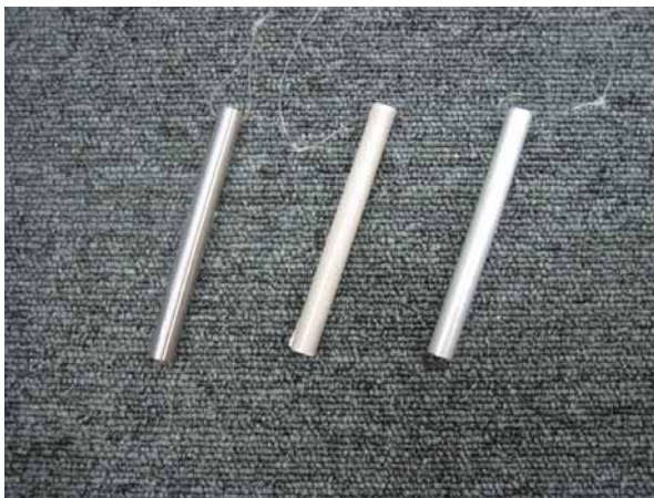
図1 さまざまな金属材料（左からステンレス鋼、マグネシウム、アルミニウム）
