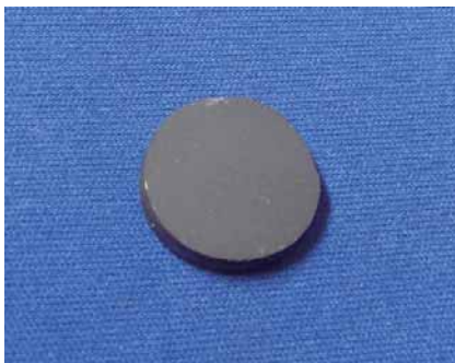
図3 MgB 2 超伝導材料 (濃い灰色の材料)
