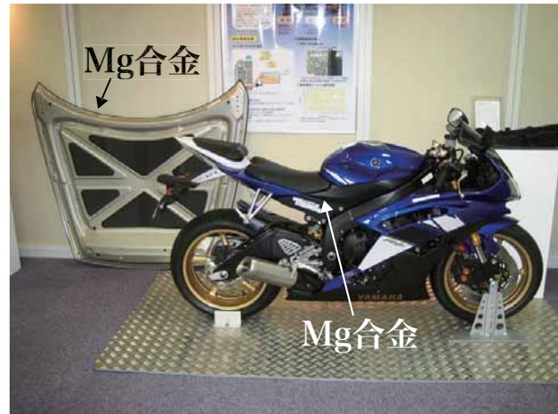
図2 マグネシウム合金でできた部品 左 奥：フレームがマグネシウム合金でできた自動車のボンネット 右手前：座席下のフレームがマグネシウムでできたオートバイ
