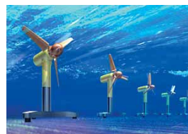
Figura 2. Impresión del artista de la generación de energía mareomotriz. Un sistema que convierte la energía cinética de las corrientes de marea en energía.
