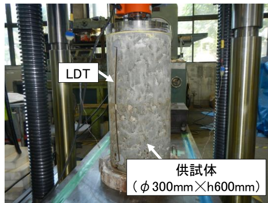
図 2.3.6 一軸圧縮試験の状況
