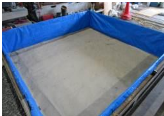
(a) 遮水シートおよび不織布の設置
